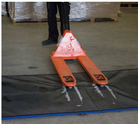
Rails de désinfection pour roulettes (pour les entrées des usines agros, des exploitations et des élevages)
