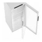
Rappel de porte automatique La porte est équipé d'un dispositif de rappel automatique pour éviter les pertes de froid lors d'une mauvaise fermeture de celle-ci. Stable à 90° pour permettre un chargement confortable de l'armoire, le dispositif de rappel automatique s'enclenche à partir de 60°.
